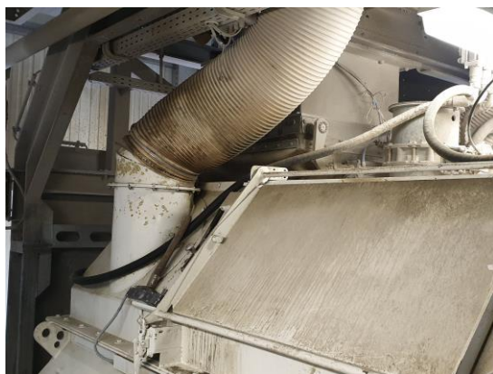
Afzuiging van de menger en weegtoestellen
