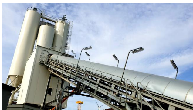
Afgesloten transportbanden, menger in afgesloten gebouw en schone lucht cementsilo's
